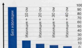
На графиках – наружная кирпичная стена толщиной 38 см с теплоизоляцией и без нее.
