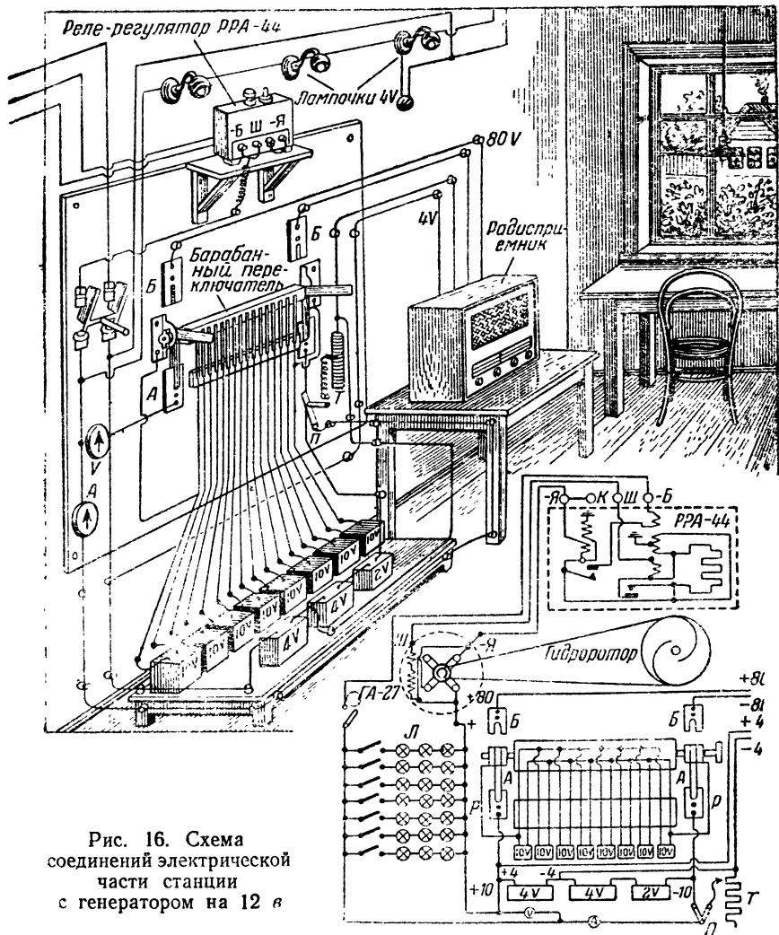
Рис. 16. Схема соединений электрической части станции с генератором на 12 в
