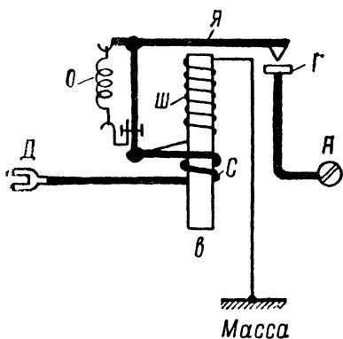
Рис. 15. Схема реле обратного тока ЦБ-4118
