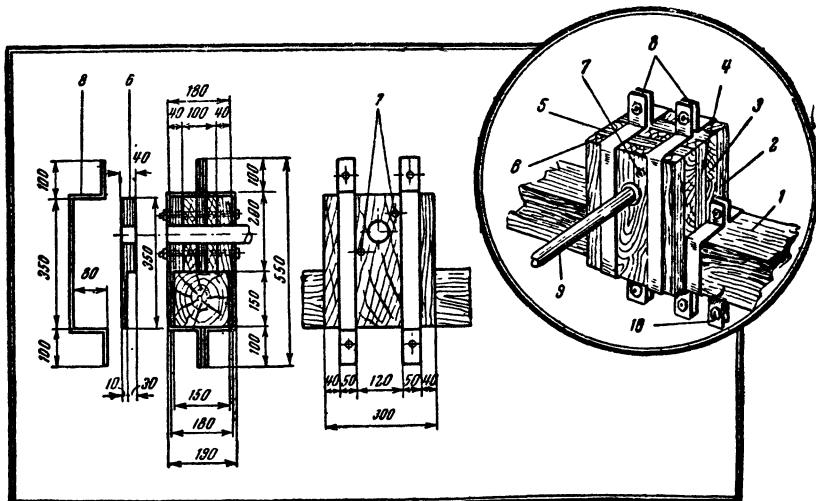
Рис. 8 Самодельный деревянный подшипник для гидроротора:
