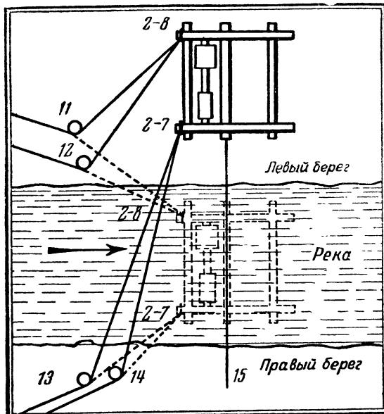
Рис. 12. План расположения каркаса с гидроротором «на салазках» перед спуском в воду. Пунктиром показано положение каркаса после его спуска в воду: 2 и 7; 2 и 8—верхние и нижние поперечины каркаса; 11 — канат, привязанный к коушу нижней поперечины 8; 13 — канат, привязанный к коушу нижней поперечины 7; 12 и 14 — канаты, привязанные к коушам двух верхних поперечин 2; 15 — тяговый канат, временно перекинутый через коуш, прикрепленный к переднему вылету средней салазки
