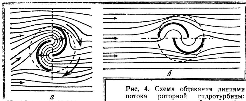
Рис. 4. Схема обтекания линиями потока роторной гидротурбины:
