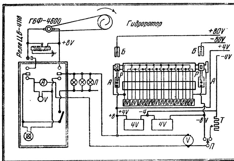
Рис. 19. Схема соединений электрической части станции с генератором на 8 в
