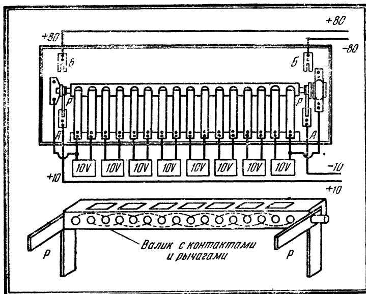
Рис. 17. Барабанный переключатель, установленный в положении на зарядку аккумуляторных батарей:  $P$ — $P$ — контактные рычаги — ножи
