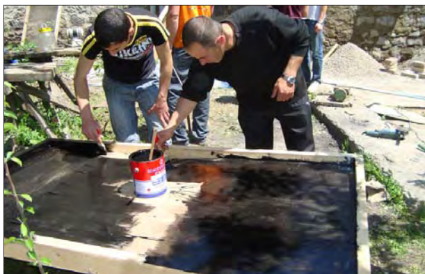
Шаг 5. Укрепите фанеру на верхнюю часть рамы, покрасьте черной, матовой краской
